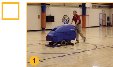
1 Scrub floor with autoscrubber, white pad and Green Light to remove heavy soil and black marks. Restriegue el piso con lavadora automática de pisos, la almohadilla blanca y Buckeye Green Light para quitar la suciedad acumulada y marcas negras.
